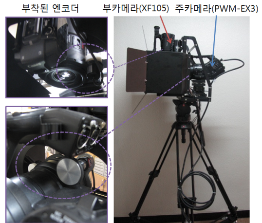
그림 3. 제작된 이종 입체 카메라 시스템
