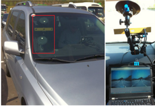
그림 12. 실험에 사용된 카메라와 차량에 장착된 모습 Fig. 12. Experimental stereo camera set up.
