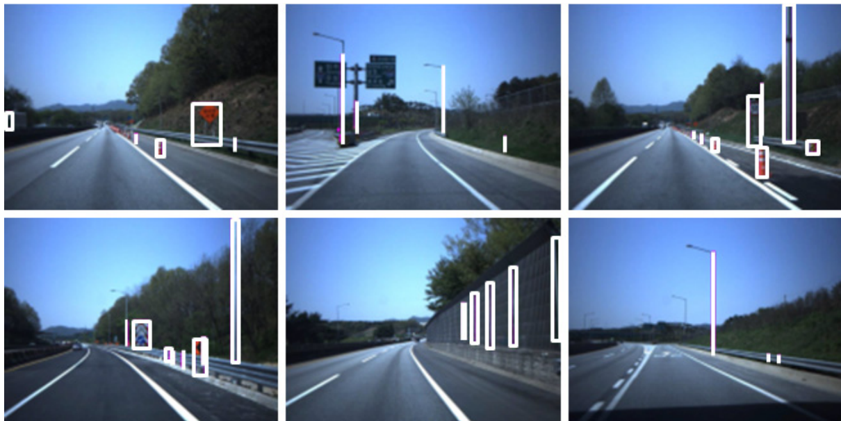
그림 14. 다양한 도로 환경에서의 수직 물체 추출 실험 결과 Fig. 14. Vertical obstacle detection in various road environment.
